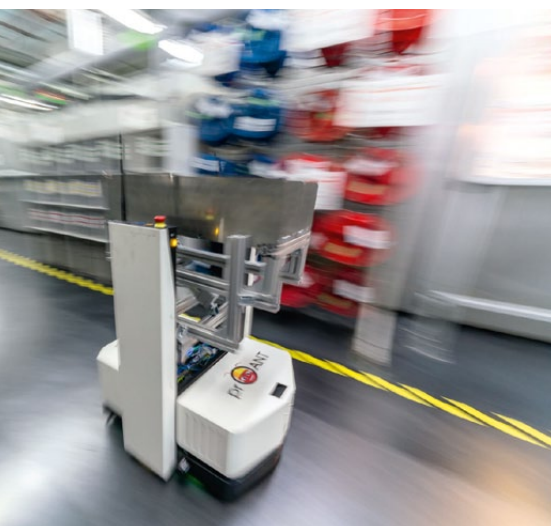
2 Transportfahrzeug mit Lastaufnahme-mittel für die Spulen
